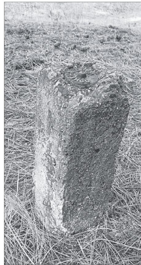
Репер на столбике имеет углубление для установки рейки, от которой геодезисты ведут отсчёт.
