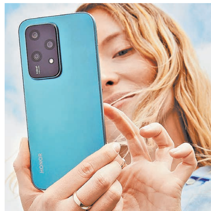
В блоке камер HONOR 200 Lite собрано три модуля. Основной — 108 мегапикселей (5 МП и модуль для макростемки — 2 МП. В целом характеристики достойные.
