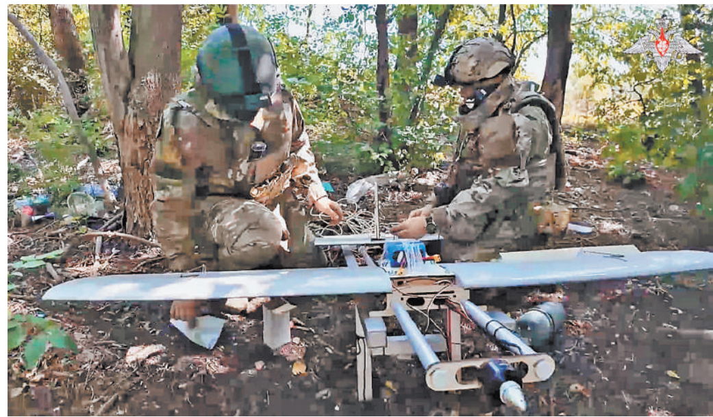
Беспилотник «Молния» может быть в воздухе до 40 минут и долететь до цели даже с простреленными крыльями.
