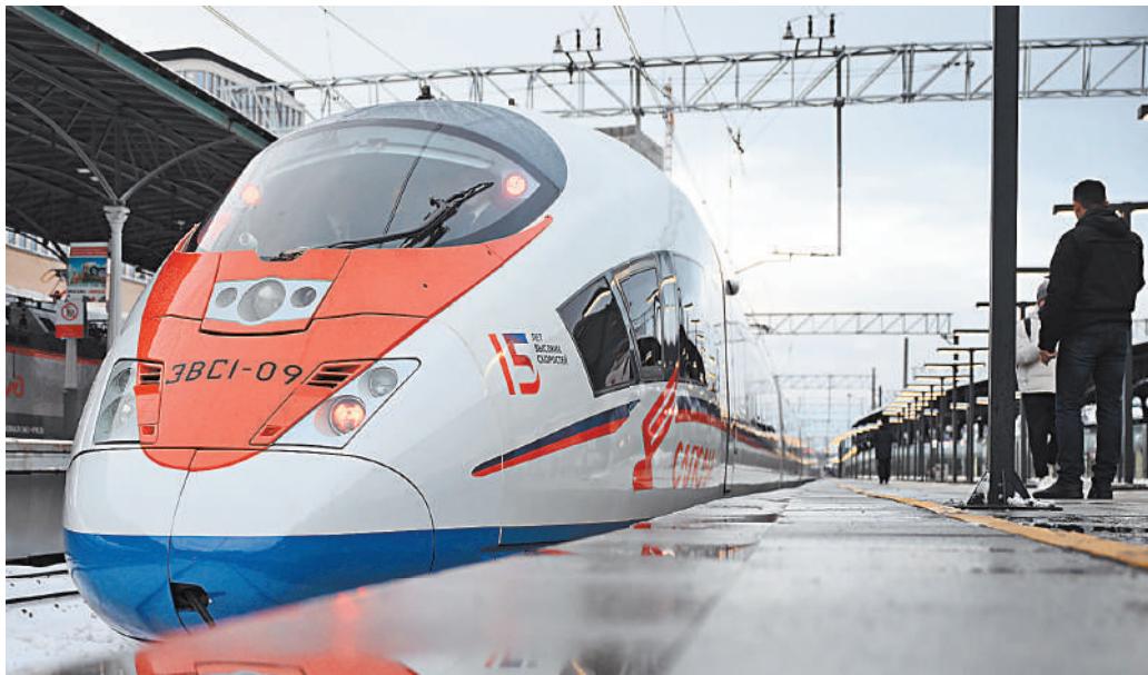
При создании «Сапсана» для России габариты поезда пришлось увеличить из-за большей ширины колеи.
